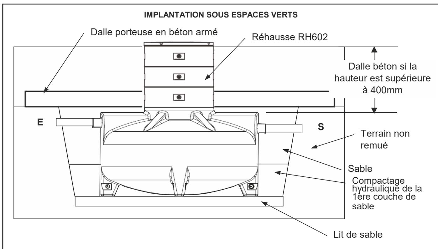
9. En cas de passage de véhicules, il y a lieu de couler une dalle porteuse en béton armé située au niveau de la réhausse juste au dessus de la génératrice de l'appareil. Cette dalle devra prendre appui sur le terrain non remué. Il sera nécessaire d'ajuster la hauteur avec une réhausse béton qui prendra appui sur la dalle porteuse en béton.
