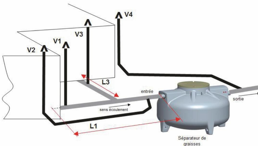
Si L1 est inférieur à 10 ml, raccorder la ventilation V1 en toiture. Si L1 est supérieur à 10 ml, raccorder la ventilation V1 et la ventilation V2 (piquage au plus près du séparateur) en toiture. Toutes les conduites raméables de longueur supérieure à 5 ml doivent être ventilées, donc si L3 est supérieur à 5ml, raccorder la ventilation V3 en toiture. La conduite aval du séparateur doit être également raccordée en toiture (V4).
