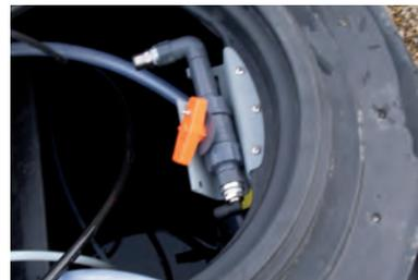
**14** Insérer le raccord cannelé de l'ensemble bloc-vanne dans le tube tressé Crystal et serrer le tout à l'aide du collier de serrage inox.
