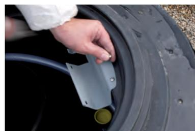
**13** Repositionner l'ensemble bloc-vanne sur l'équerre.
