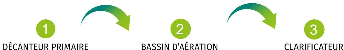
Le décanteur primaire reçoit les eaux usées domestiques brutes et permet de réaliser une première séparation des matières en suspension (macro-déchets) et des flottants (graisses...).
