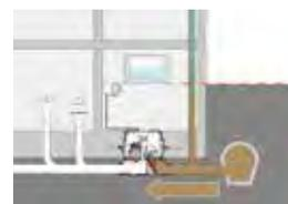
2. Clapet empêchant le refoulement.
