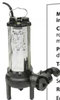
**Monophasé es 230 V avec condensateur intégré au coffret ou Triphasés 400 V.****Construction :** corps de pompe et roue Vortex en fonte, enveloppe moteur inox.**Protection :** IP68 classe d'isolation F.**Température des liquides :** maxi +50°C,**Utilisation :** eaux chargées.
