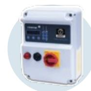
**Panneau de commande électronique** avec auto-apprentissage pour démarrage direct des pompes monophasées ou triphasées, et avec protection contre le fonctionnement à sec via  $\cos \varphi$  et courant minimum.
